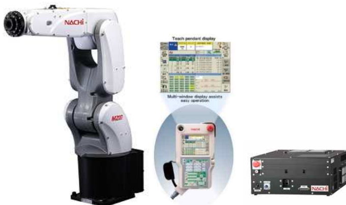
▶ MZ04D-01 (다관절 6축 로봇 시스템 4kg)
