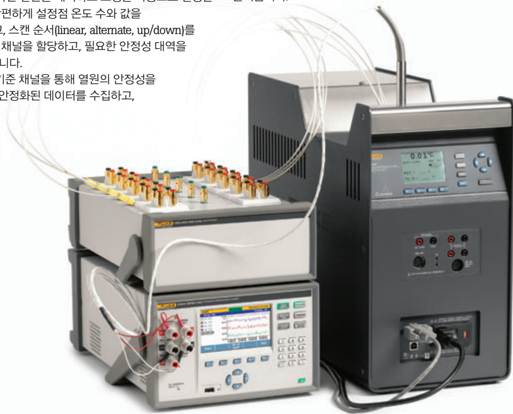
DAQ-STAQ와 9190A Ultra-Cool Field Metrology Well로 구성되어 센서 교정을 자동화한 1586A
